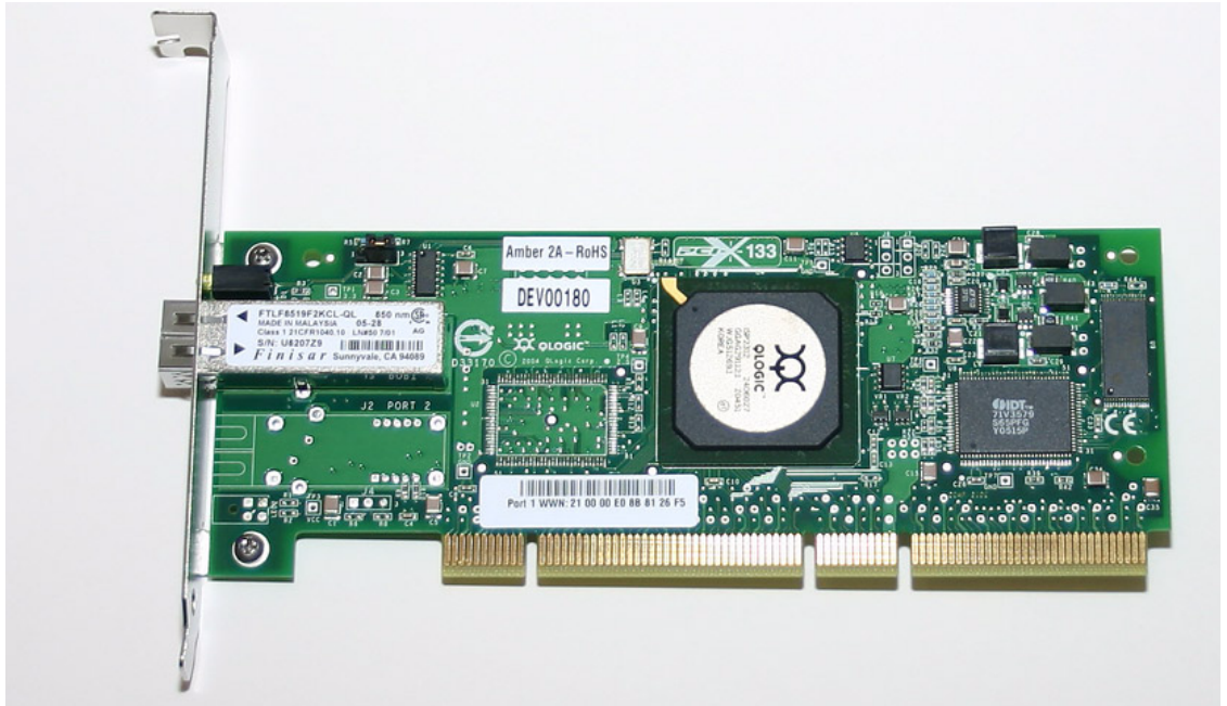
FIGURE 3 HBA à accès simple FC 2 Go PCI-X Sun StorageTek Enterprise (protections retirées)
