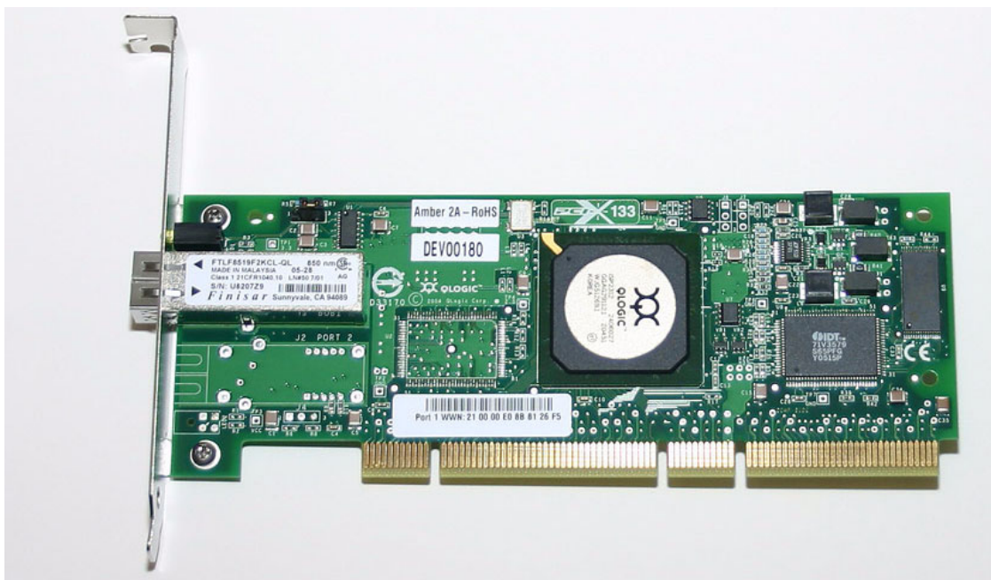
図 3 Sun StorageTek PCI-X Enterprise 2 Gb FC Single Port HBA (ダストカバーを取り外した状態)
