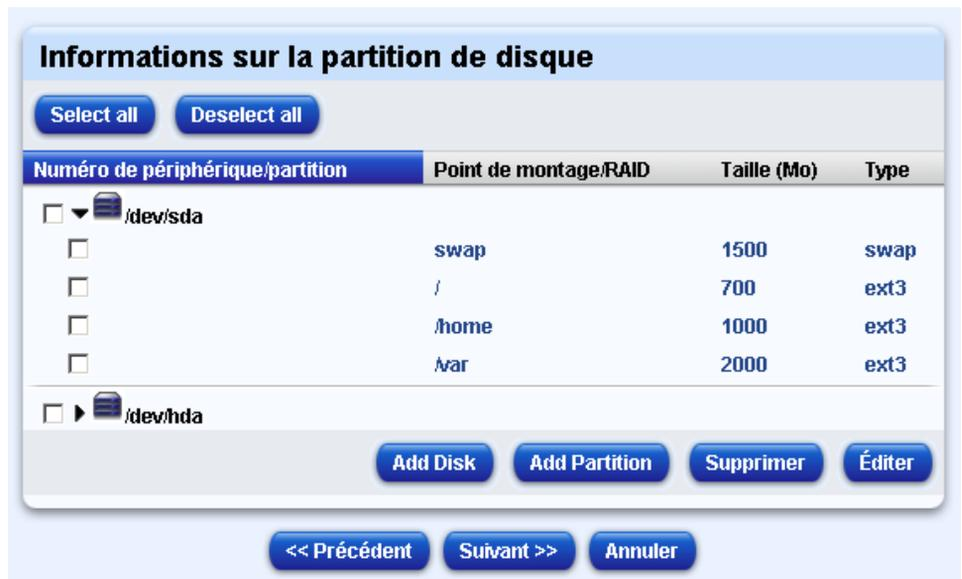
FIGURE 2-9 Exemple de tableau Informations sur la partition de disque pour Sun JDS
