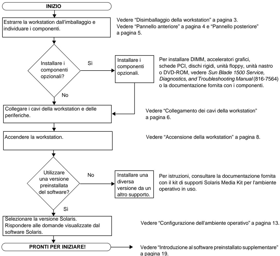
**FIGURA 1-1** Processo di installazione della workstation Sun Blade 1500
