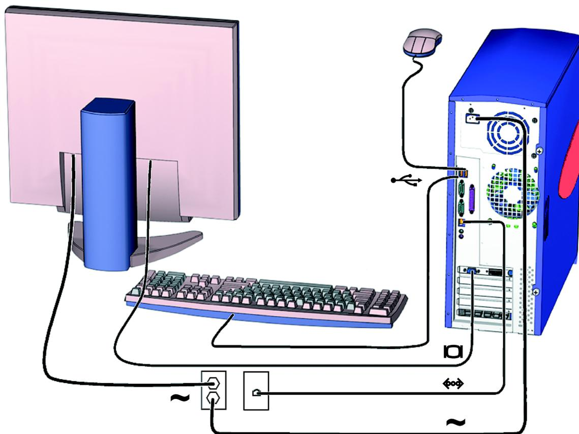
FIGURA 1-5 Illustrazione del cablaggio
