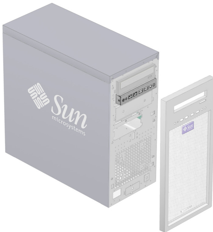
图 4-30 机箱中 I/O 板组件的位置
