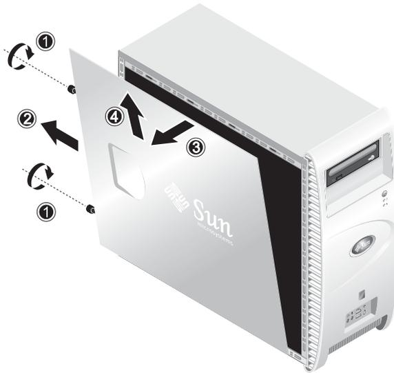
**ABBILDUNG 4-1** Entfernen der linken Gehäusewand
