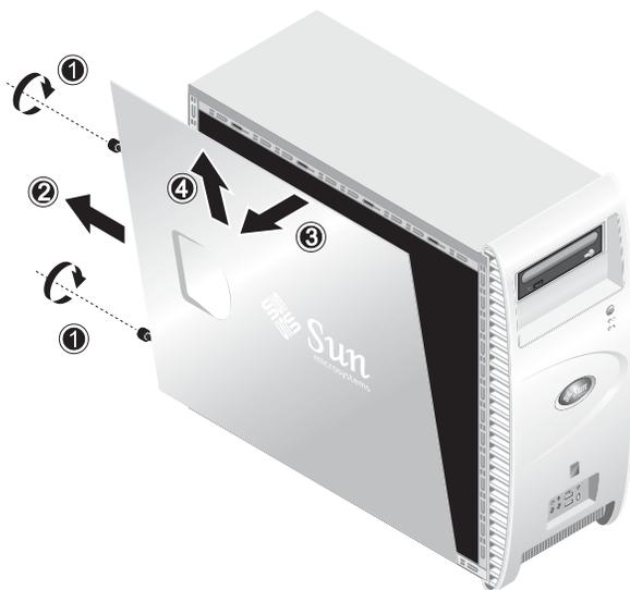
**FIGURA 4-1** Rimozione del pannello laterale sinistro
