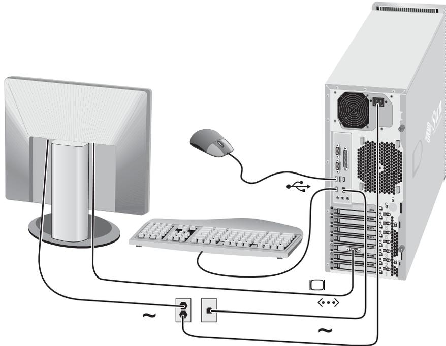
**ABBILDUNG 1-4** Kabelverbindungen
