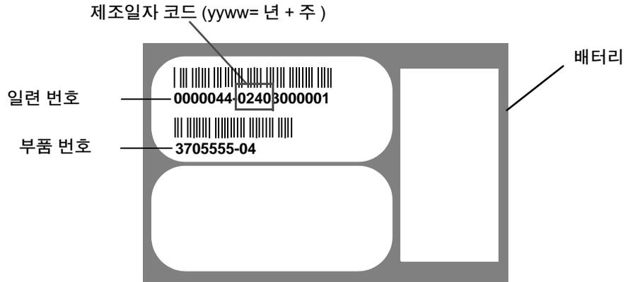
그림 4-1 Sun StorEdge 3310 SCSI Array 에 대한 배터리 레이블 예
