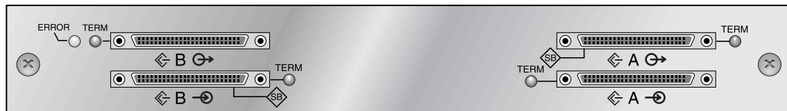
FIGURE 4-21 Configuration à bus scindé d'une unité d'extension
