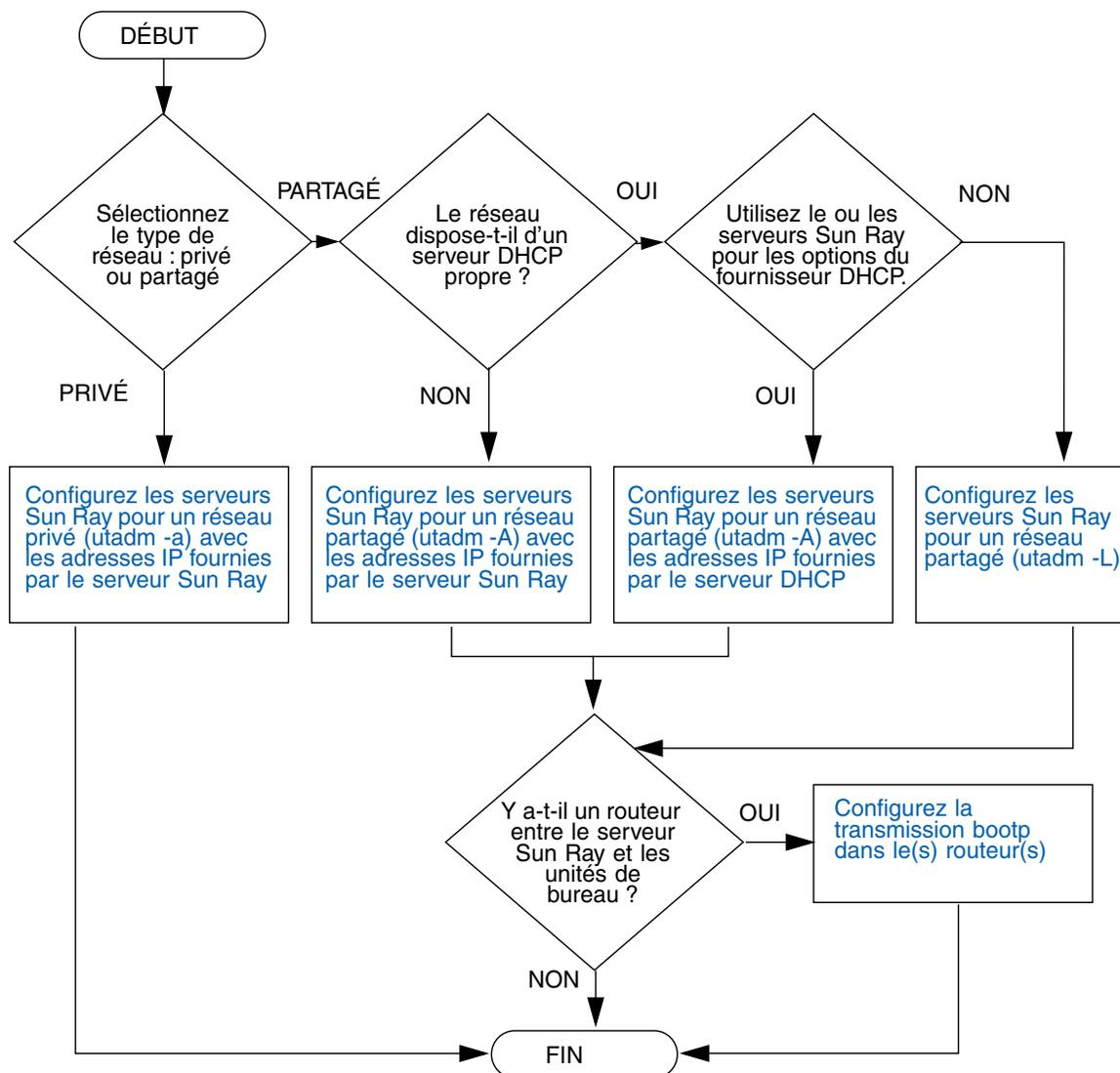
FIGURE 1-2 Configuration Sun Ray pour différents types de réseaux
