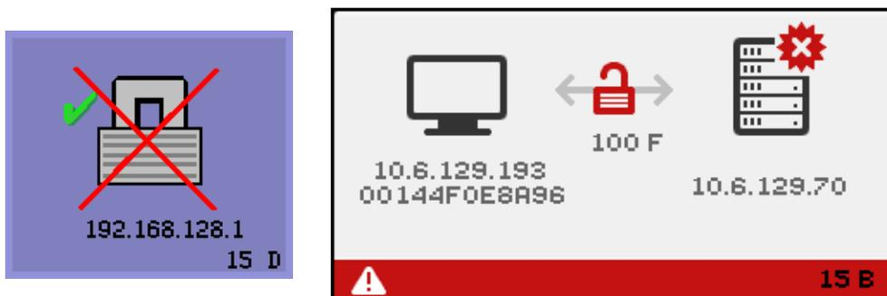
アイコン 15D は、Sun Ray サーバーの有効性が確認できないため、クライアントがサーバーへの接続を拒否していることを示します。このエラーは、不明な Sun Ray サーバーがメッセージを傍受した場合にのみ発生します。この場合、有効な Sun Ray サーバーがエミュレートされます。これはセッションのセキュリティー違反です。
