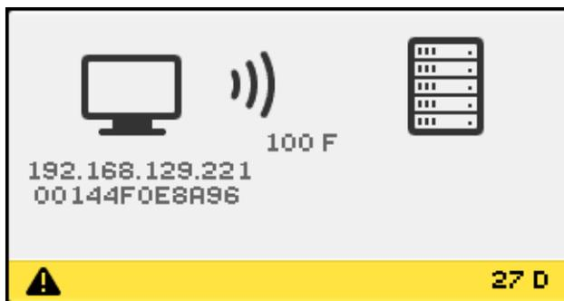
DTU が VPN 接続を確立しようとしている間、次のアイコンが表示されます。
