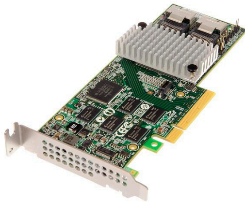
그림 1.1. Oracle의 Sun Storage 6Gb SAS PCIe RAID HBA, 내부
