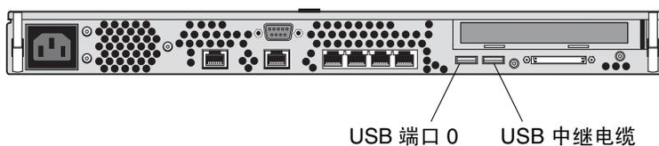
图 2-19 存储服务处理器：USB 端口 0
