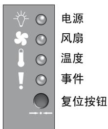
图 6-2 前面板上的机架盖 LED 指示灯和复位按钮
