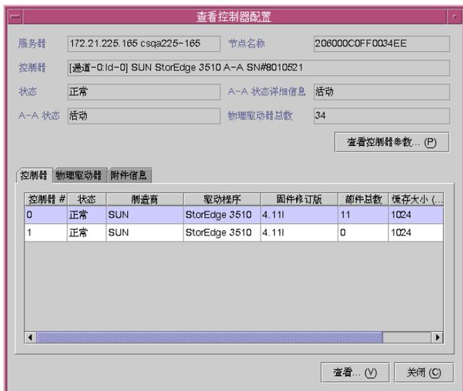
该窗口底部的选项卡提供了关于 RAID 控制器的 LUN、与之连接的物理驱动器、控制器所在的附件以及外围设备配置的详细信息。要了解有关视图内其他选项卡的信息，请单击该选项卡。
