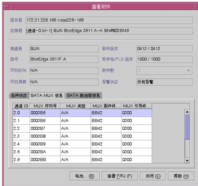
要查看 RAID 控制器后所有可访问的 SATA 路由器，请单击“SATA 路由器信息”选项卡。显示的信息包括：SATA 路由器所在机箱的附件 ID 和附件序列号、路由器控制的通道号、路由器所在 IOM 板的插槽位置、路由器固件版本号、路由器固件引导修订版本、CSB（客户指定的行为）修订版本（定义路由器操作行为的内存驻留参数的集合）、硬件修订版本号和自检修订版本号。
