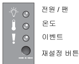
그림 6-2 전면 패널의 새시 손잡이 LED 및 재설정 버튼
