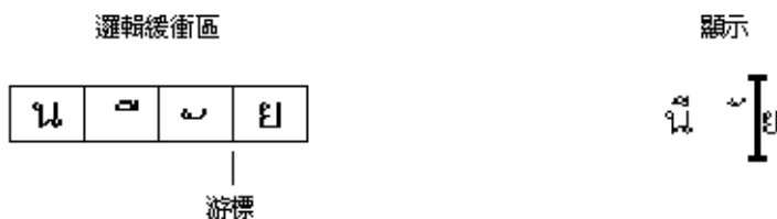
圖 D-2 文字插入後的邏輯緩衝器和顯示器
