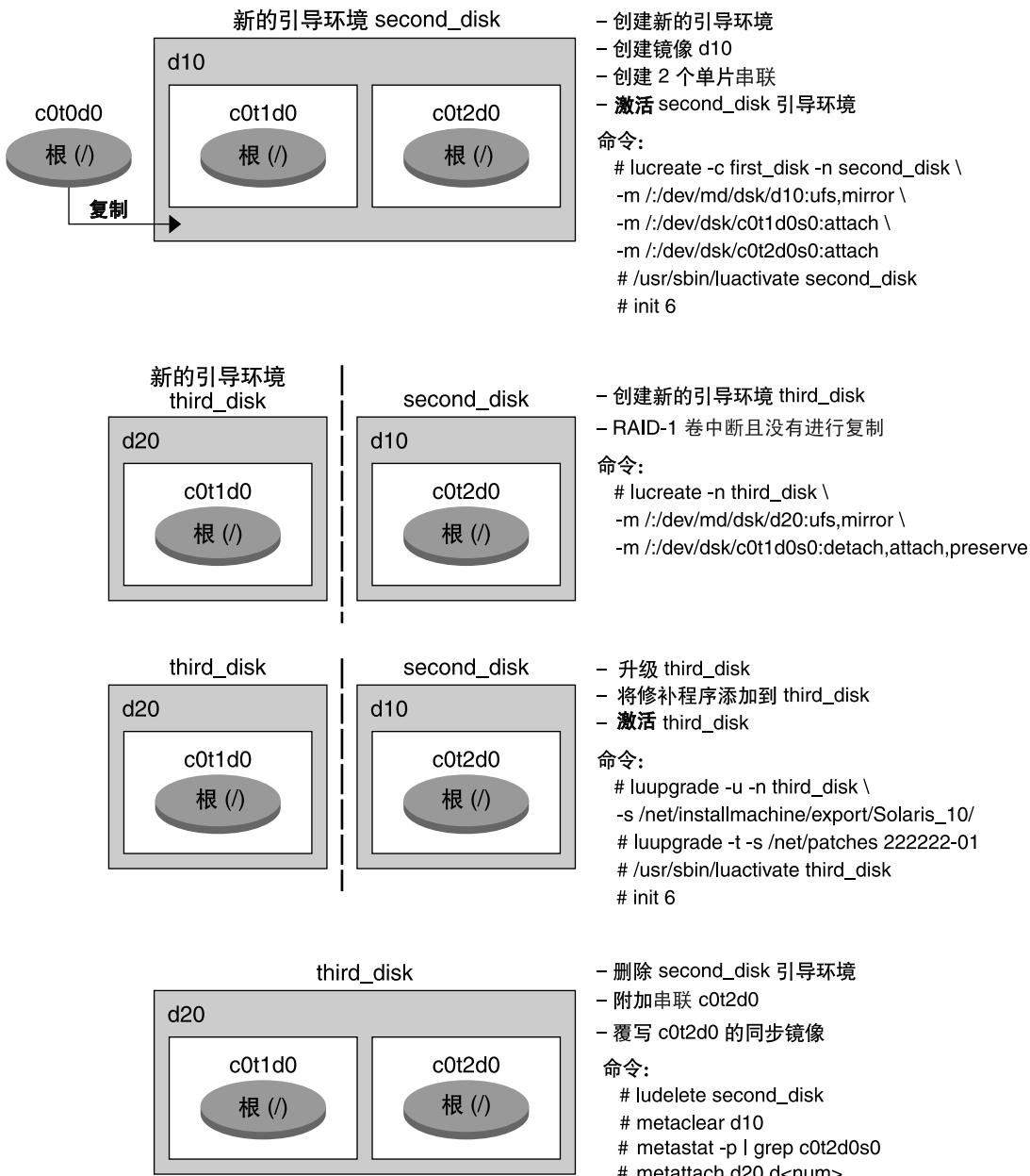
图 9-2 拆离和升级 RAID-1 卷（镜像）的一面（继续）
