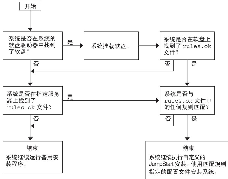
图 2-3 自定义 JumpStart 安装过程中执行的操作
