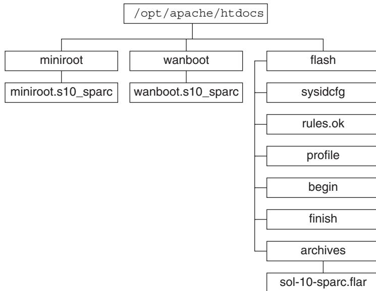
图 11-1 文档根目录结构样例
