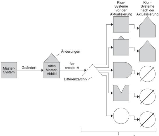
Installation von Klon-Systemen mit Änderungen und Überprüfung der Master- und Klon-Systemabbilder.
