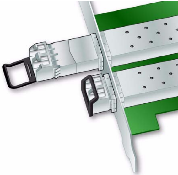
圖 2-2 部分抽出的光纖收發器和完全鎖定位的光纖收發器
