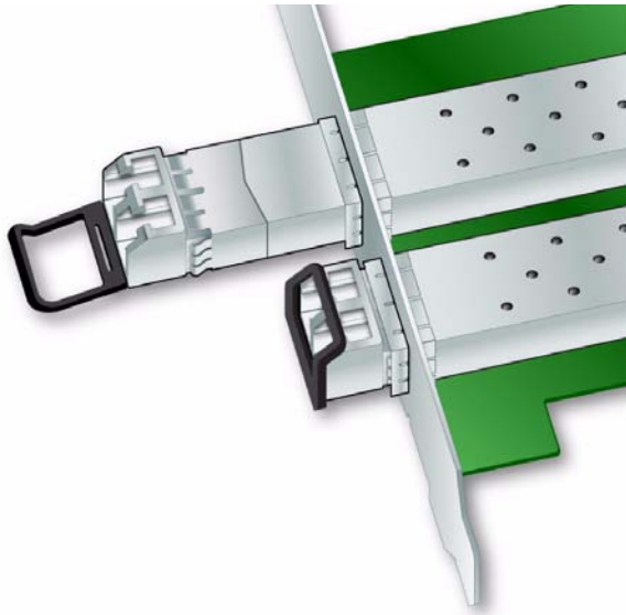
图 2-2 部分拔出的光纤收发器和锁定到位的光纤收发器
