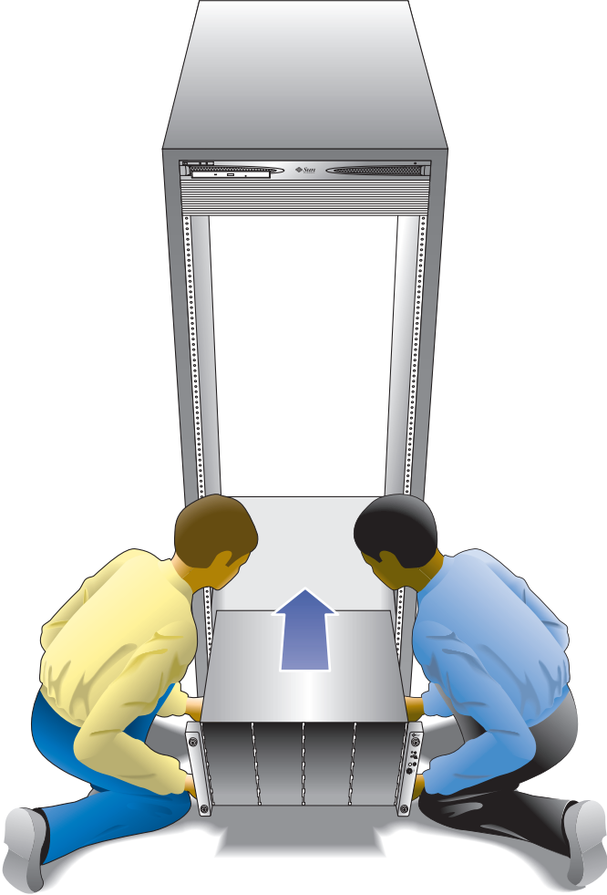
FIGURE 2-13 Mise en place de la baie J4400 dans l'armoire
