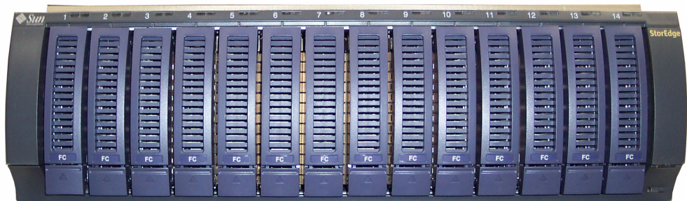
FIGURE 1-4 Avant du boîtier contrôleur Sun StorEdge 5300 RAID EU avec unités de disque Fibre Channel
