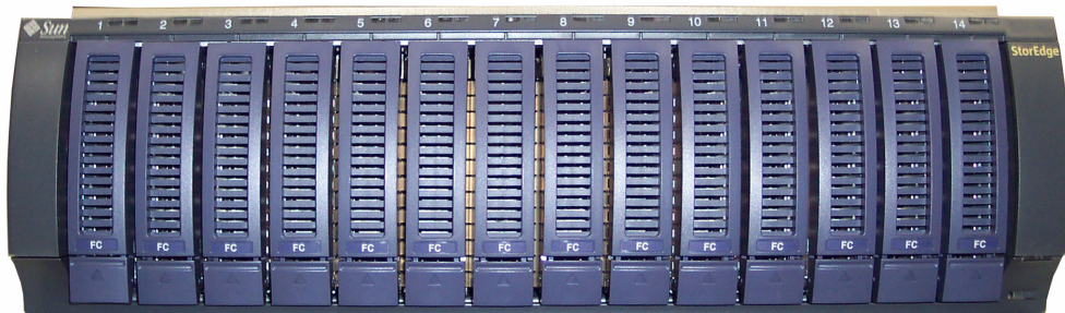
FIGURE 1-6 Avant du boîtier d'extension Sun StorEdge 5300 EU F avec unités de disque Fibre Channel
