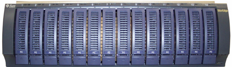
그림 1-4 광 섬유 채널 디스크 드라이브가 장착된 Sun StorEdge 5300 RAID EU 제어기 외장 장치 전면
