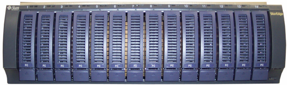
그림 1-6 광 섬유 채널 디스크 드라이브가 장착된 Sun StorEdge 5300 EU F 확장 외장 장치 전면
