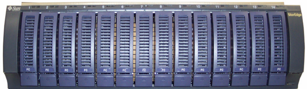
圖 1-6 具有光纖通道磁碟機的 Sun StorEdge 5300 EU F 擴充附件正面圖
