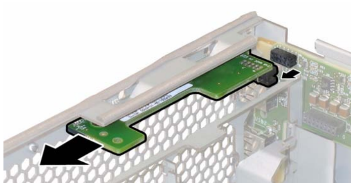
图 12-10 拆卸前面板指示灯板
