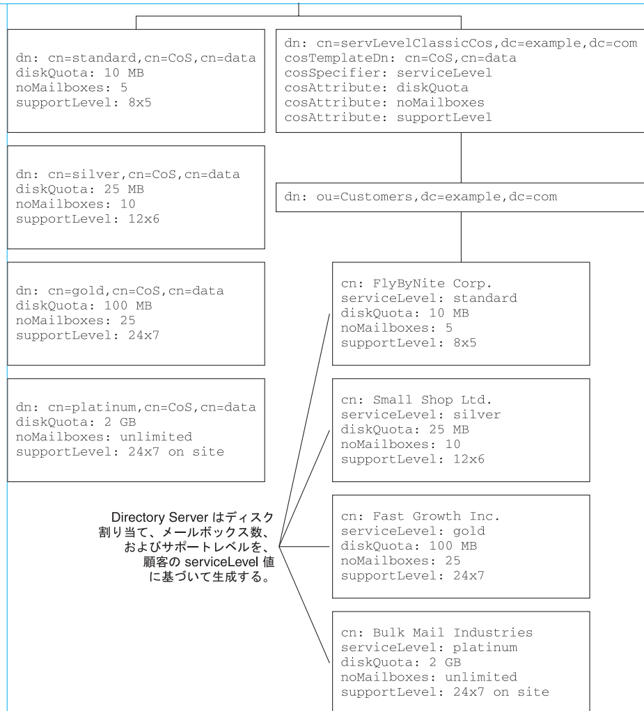
図 4-6 クラシック CoS を使用したサービスレベルデータの生成
