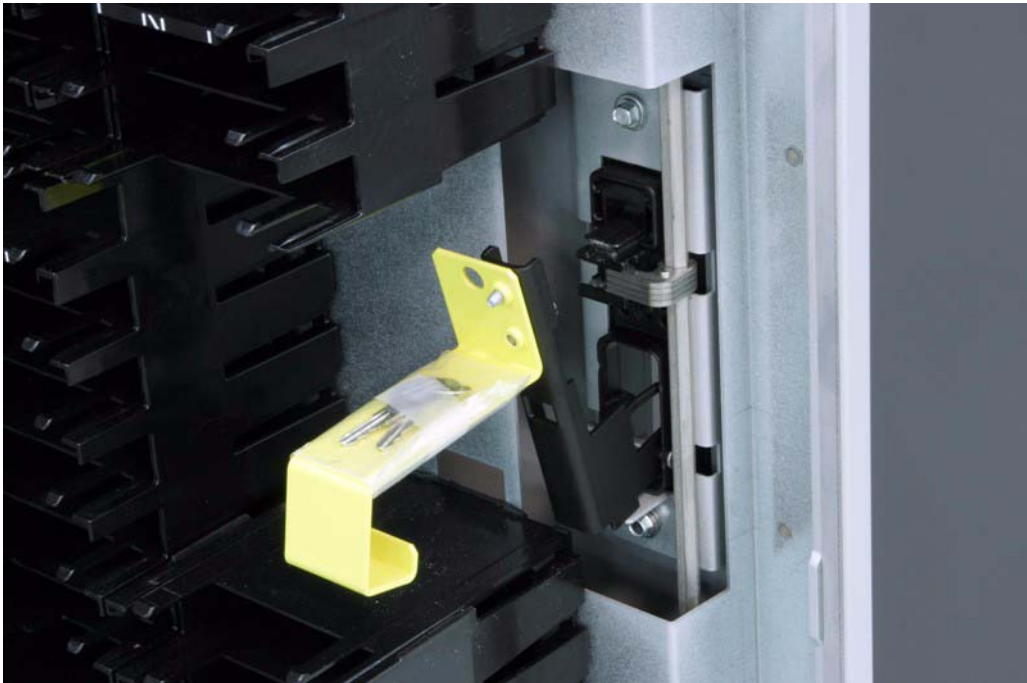
FIGURA 8-1 Palanca liberadora mecánica de la puerta
