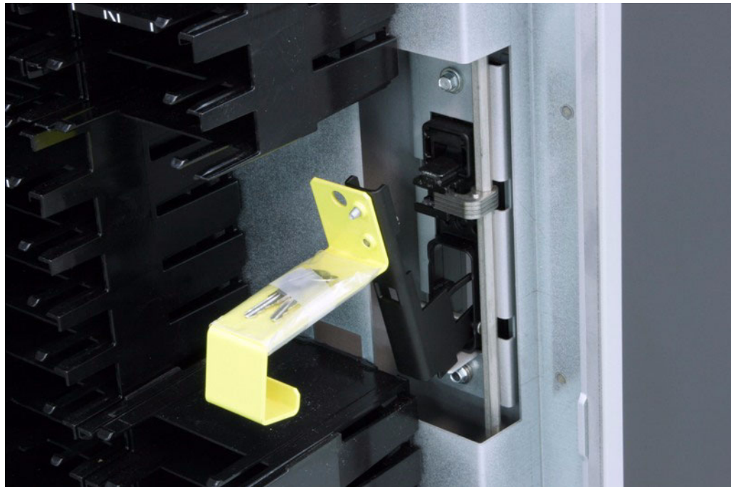
FIGURA 8-1 Meccanismo di rilascio della porta
