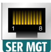
このポートはサーバーの管理に使用します。このポートは、90 ページの「サービスプロセッサのネットワーク管理ポートを使用可能にする方法」に記載されているように、サービスプロセッサのネットワーク管理ポートを設定する際に必要になります。
