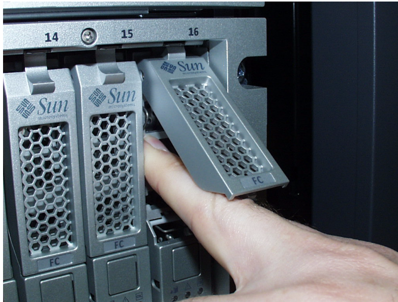
FIGURE A-3 Méthode incorrecte d'insertion d'un disque dur
