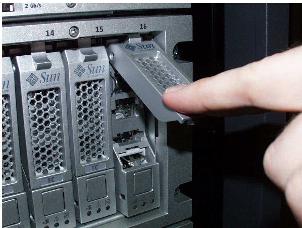
FIGURE A-1 Insertion d'une unité de disque
