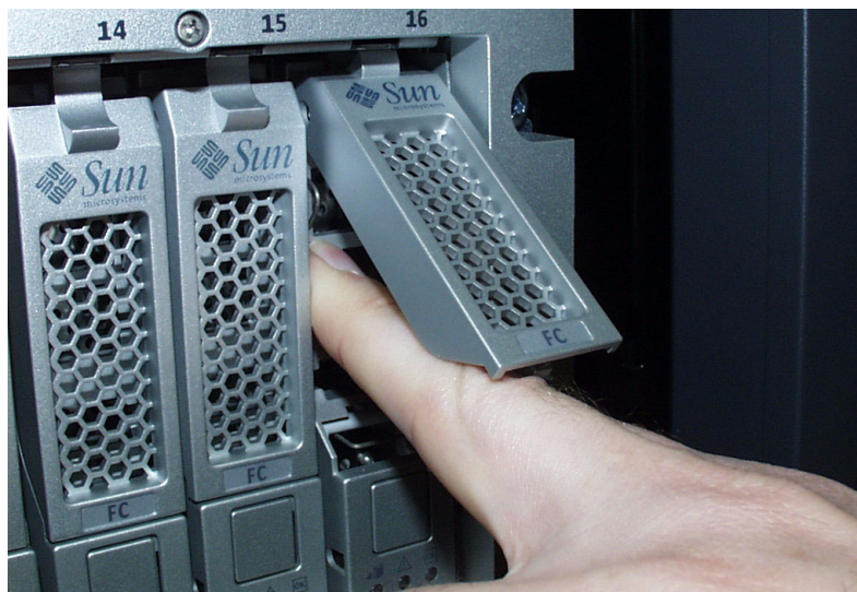
図 B-3 間違った方法でのハードドライブの挿入
