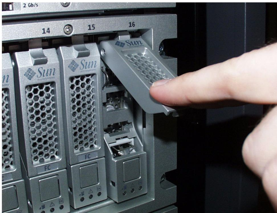
ドライブが完全に挿入されたら、図 A-2 に示すようにドライブとハンドルが同じ高さになります。
