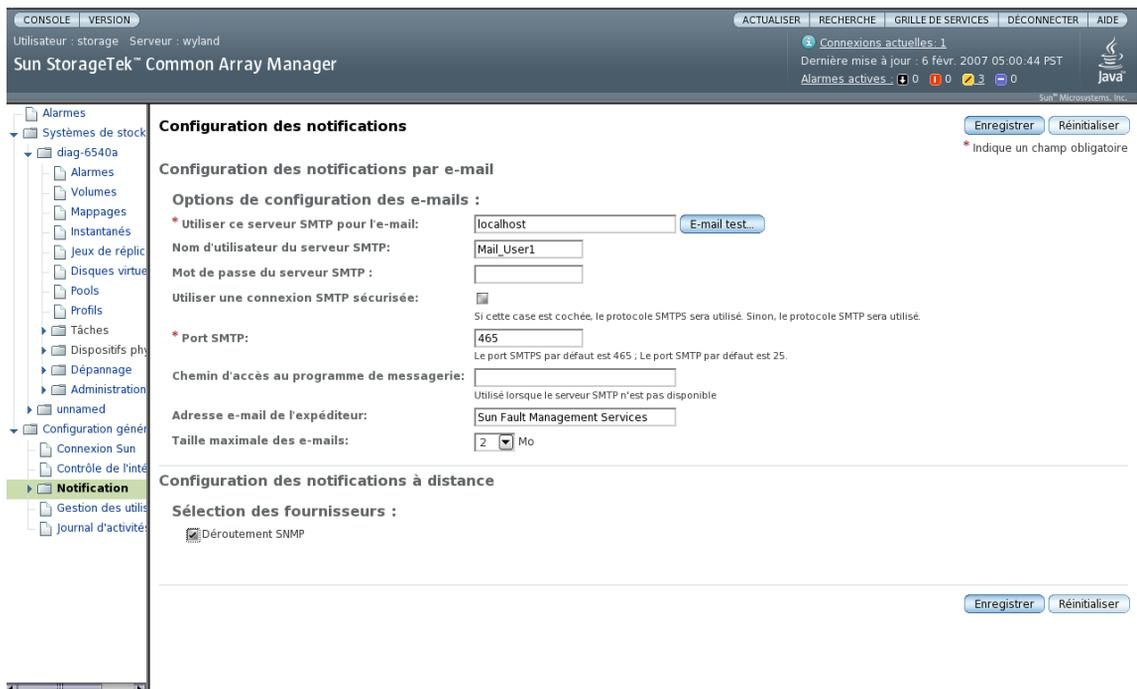
FIGURE 3-1 Configuration des notifications d'erreur par e-mail
