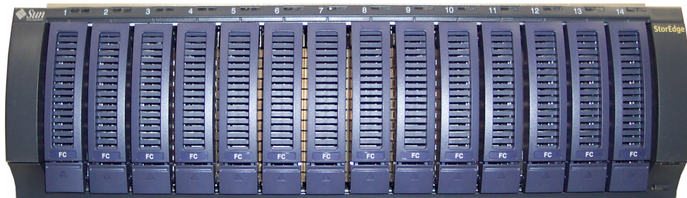
FIGURA 1-7 Parte delantera del chasis de expansión Sun StorEdge 5300 EU F, con unidades de disco FC
