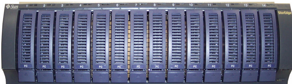
FIGURA 1-5 Parte frontal del chasis de controlador Sun StorEdge 5300 RAID EU, con unidades de disco FC
