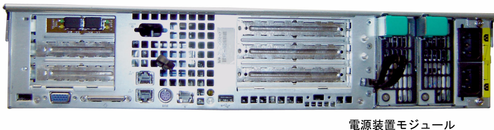
図 D-1 電源装置
