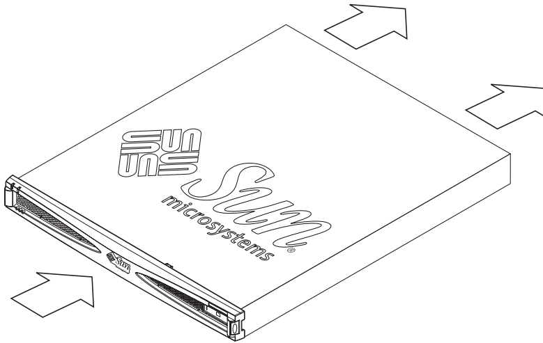
ABBILDUNG 1-12 Erforderliche Luftströmung (Vorder- und Rückseite)
