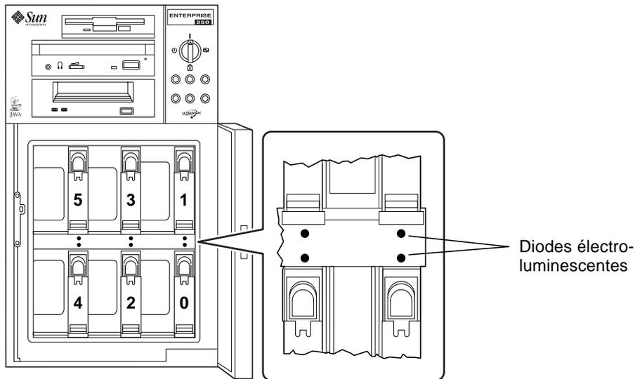
**FIGURE 2-2** Numérotation des emplacements d'unité de disque et emplacement des diodes électroluminescentes
