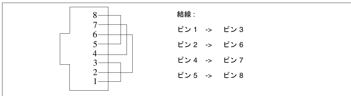
図 A-16 Gigabit および 10/100 Ethernet 用 TPE ループバックケーブルの結線
