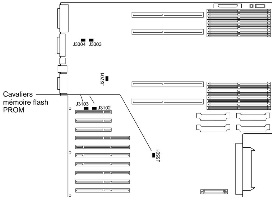
**FIGURE 5-7** Cavaliers de la mémoire flash PROM sur le système Sun Enterprise 450 et la station de travail Sun Ultra 450
