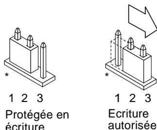
FIGURE 5-3 Positionnement du cavalier pour permettre l'écriture
