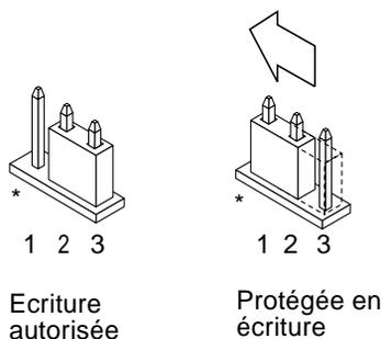
**FIGURE 5-5** Remettre le cavalier d'interdiction/autorisation d'écriture en position de protection en écriture
