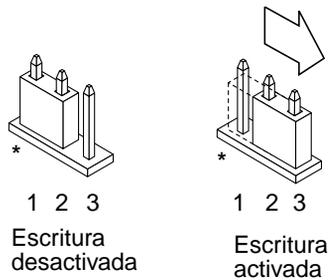
**FIGURA 5-8** Configuración del puente J3103 de activación/desactivación de la escritura en el Sun Enterprise 450 o la estación Ultra 450
