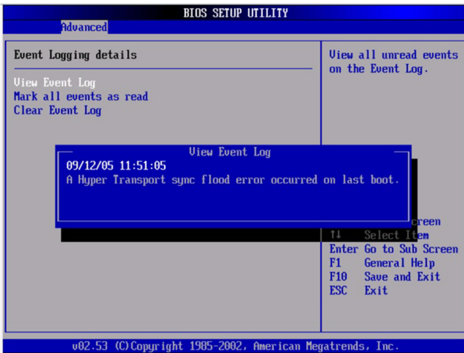
FIGURE D-1 Écran de journal DMI, erreur non corrigible
