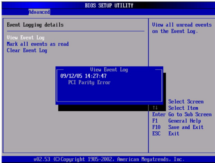
FIGURE D-4 Écran de journal DMI, erreur de parité PCI
