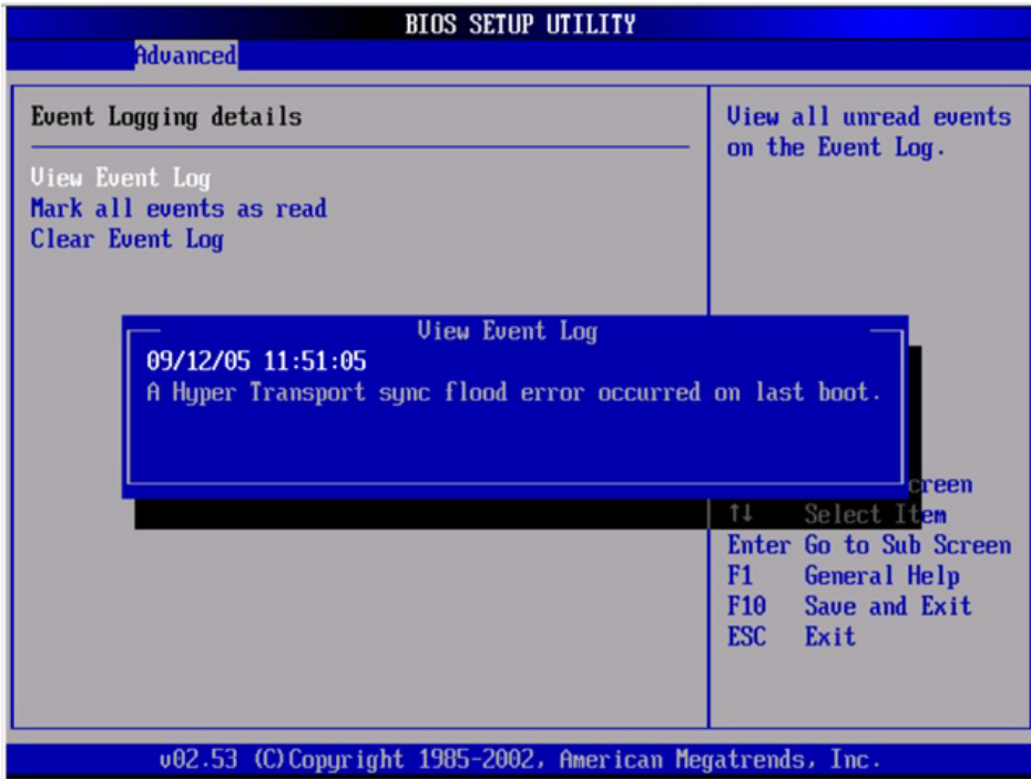
图 H-1 DMI 日志屏幕，无法修复的错误
