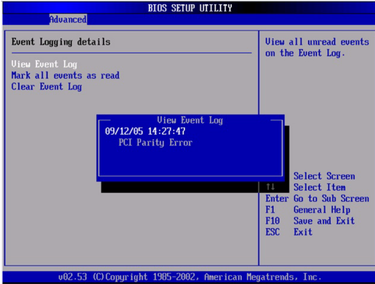
图 H-4 DMI 日志屏幕，PCI 奇偶校验错误
