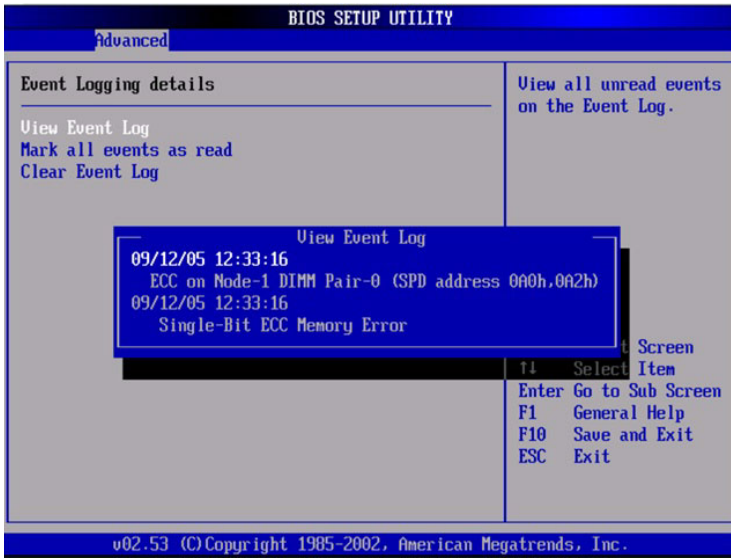
图 D-2 DMI 日志屏幕，可修复的错误
