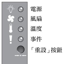
圖 7-2 前面板上的機架蓋 LED 和重設按鈕
