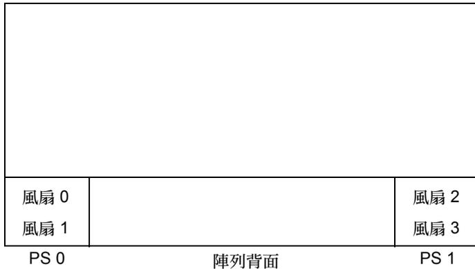
圖 8-1 散熱風扇的位置
