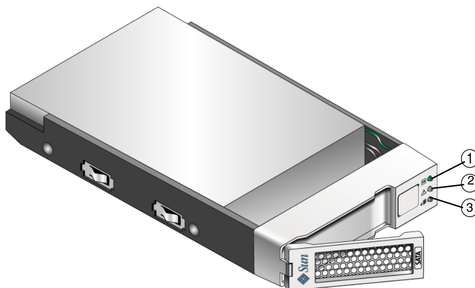
FIGURE 1-16 Emplacements des DEL des unités de disque
