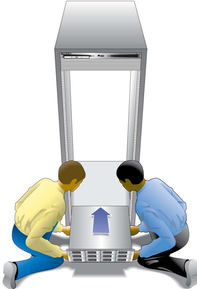
FIGURE 2-12 Mise en place du plateau de contrôleur dans l'armoire
