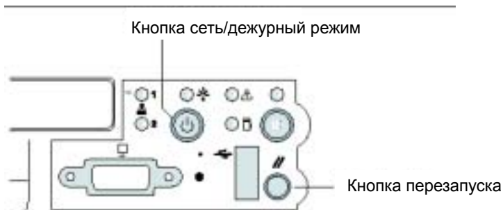
РИСУНОК 2-25 Расположение кнопки питания сервера Sun Fire V60x
