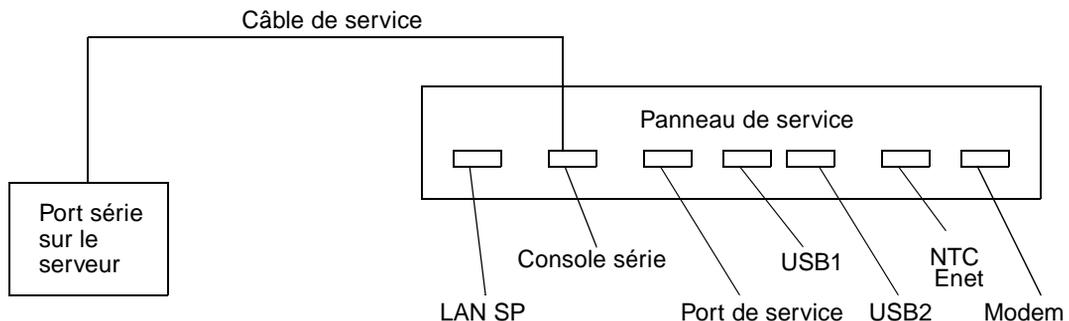
**FIGURE 5-1** Connexion du câble de service à un serveur
