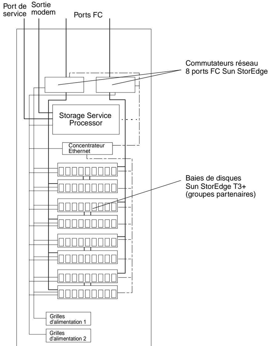
**FIGURE 8-1** Câblage du système de stockage Sun StorEdge 3910
