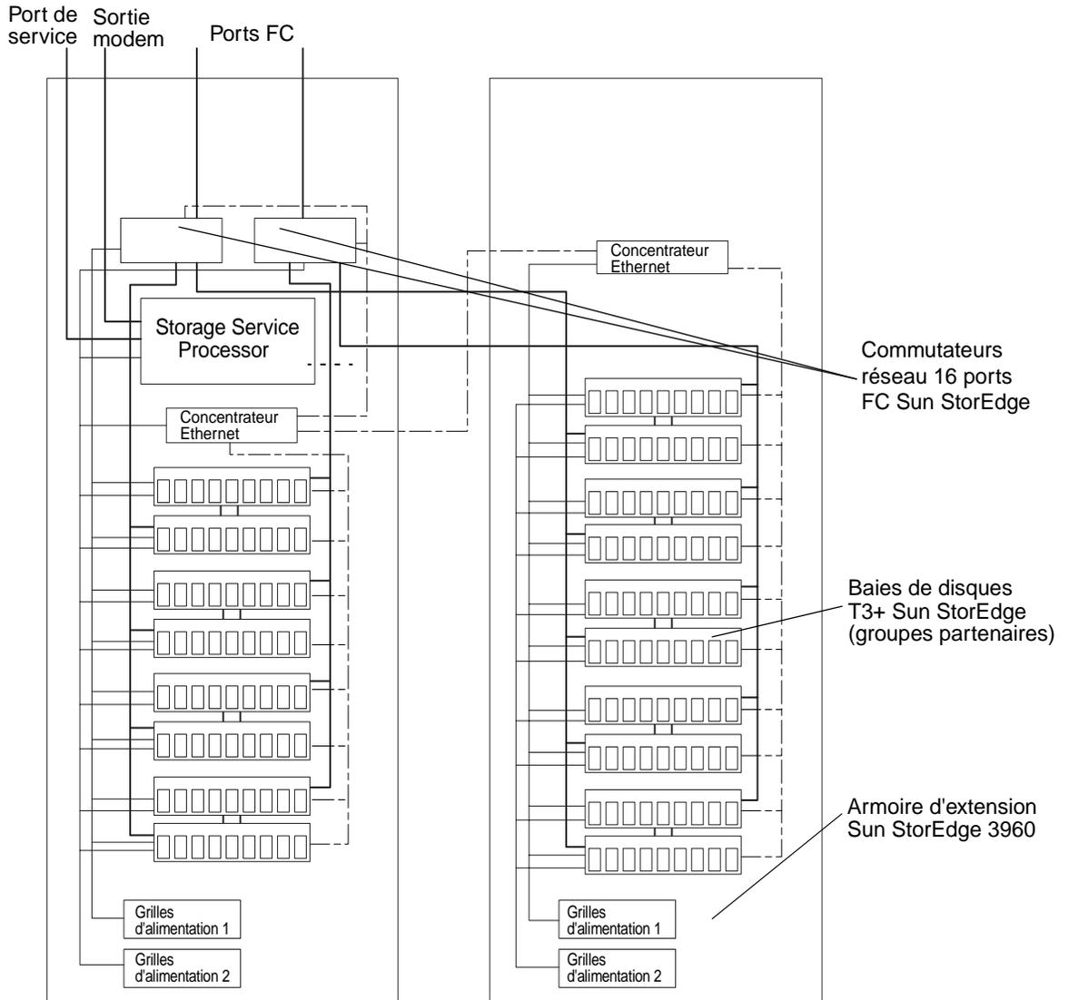
**FIGURE 8-3** Câblage du système Sun StorEdge 3960
