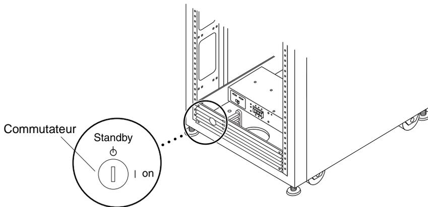
FIGURE 4-5 Emplacement du commutateur au bas du panneau avant
