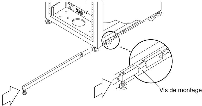
**FIGURE 2-3** Installation du pied de stabilisation droit
