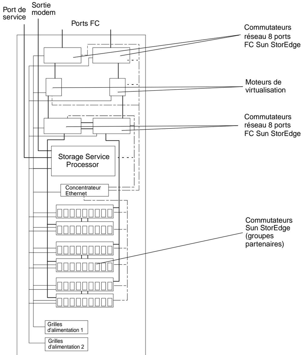
**FIGURE 8-2** Câblage du système de stockage Sun StorEdge 6910
