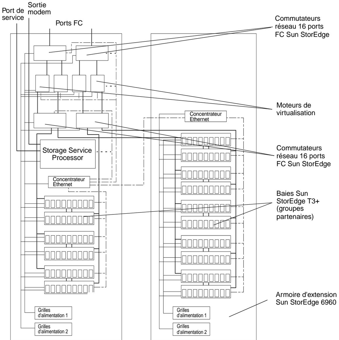
**FIGURE 8-4** Câblage du système de stockage Sun StorEdge 6960
