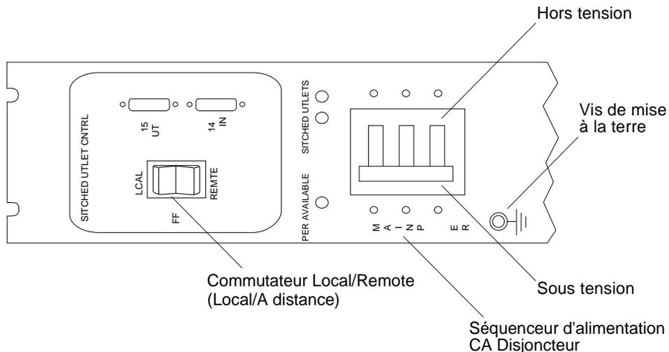
**FIGURE 4-6** Panneau de contrôle d'un séquenceur d'alimentation CA
