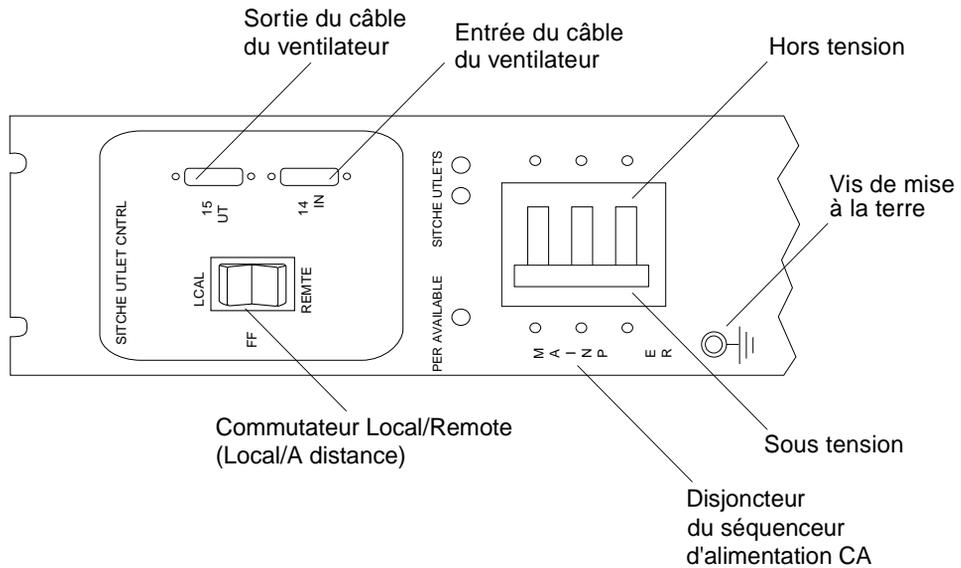
**FIGURE 4-2** Panneau de contrôle du séquenceur d'alimentation
