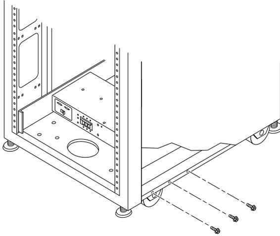
**FIGURE 2-5** Retrait des vis de montage
